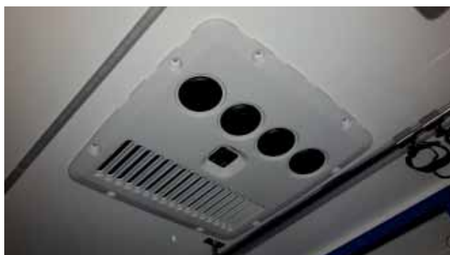
Vnitřní panel pro střešní jednotku
